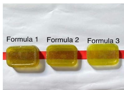
Gambar 1. Hasil Uji Perbandingan Tingkat Transparansi Sabun Batang Ekstrak Sirih Cina Berdasarkan Tiga Formula dengan Variasi Konsentrasi Sukrosa dan Etanol
