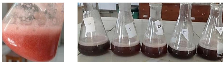
Gambar 5. Tahapan Penetapan Kadar (a) Sebelum Di Titrasi dan (b) Sesudah Titik Akhir
