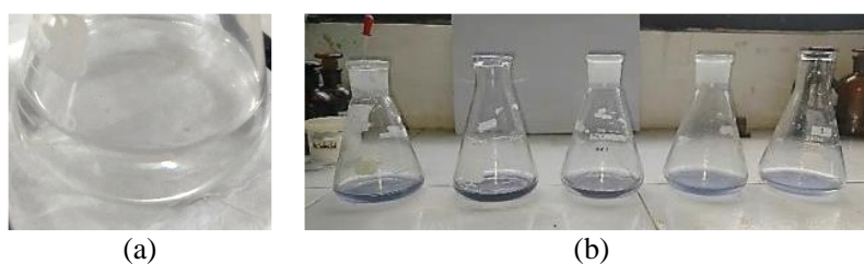
Gambar 3. Tahapan Pembakuan Larutan Iodium (a) Sebelum Di Titrasi dan (b) Sesudah Titik Akhir
